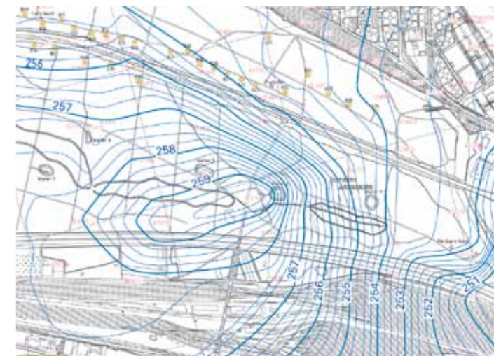
Abb. 3: Die Tiefenlinien (Isohypsen) zeigen die Grundwasserverteilung im Hardwald (orange Punkte: Brunnen).
